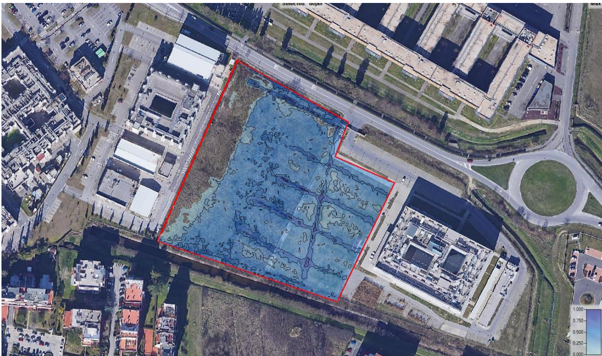
Battenti relativi su Immagine satellitare – Isolinee a 25 cm
