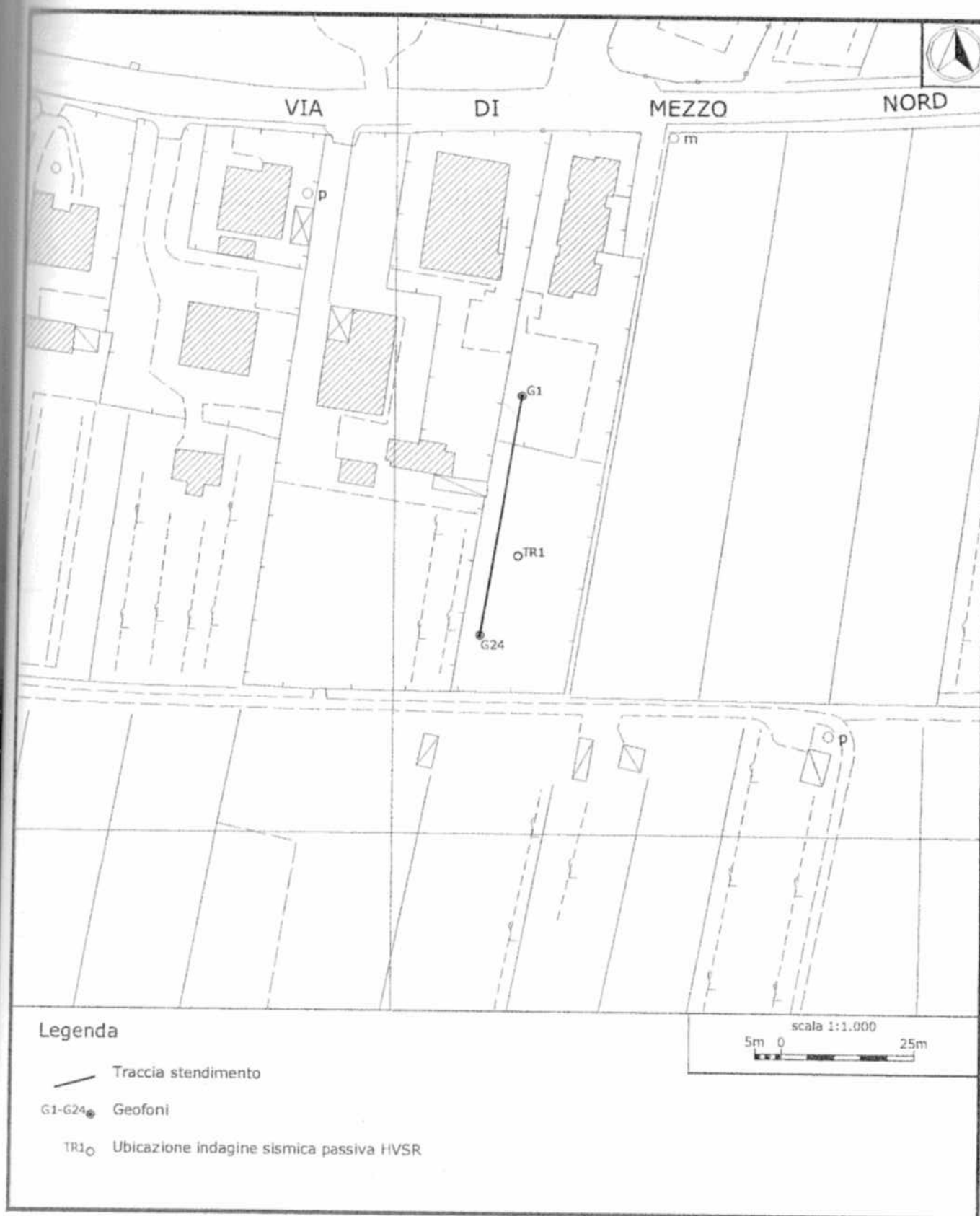
Figura 2. Particolare stendimento MASW e ubicazione indagine sismica passiva HVSr
