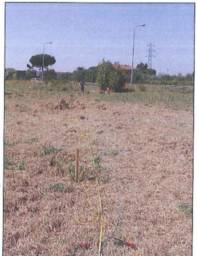
Il Masw: stesa sismica lato shot diretto;
