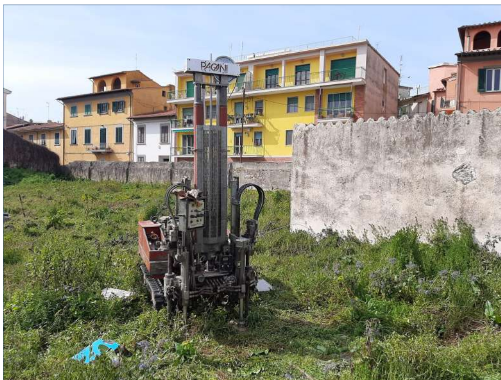
Figura 1: Postazione prova penetrometrica CPT 1
