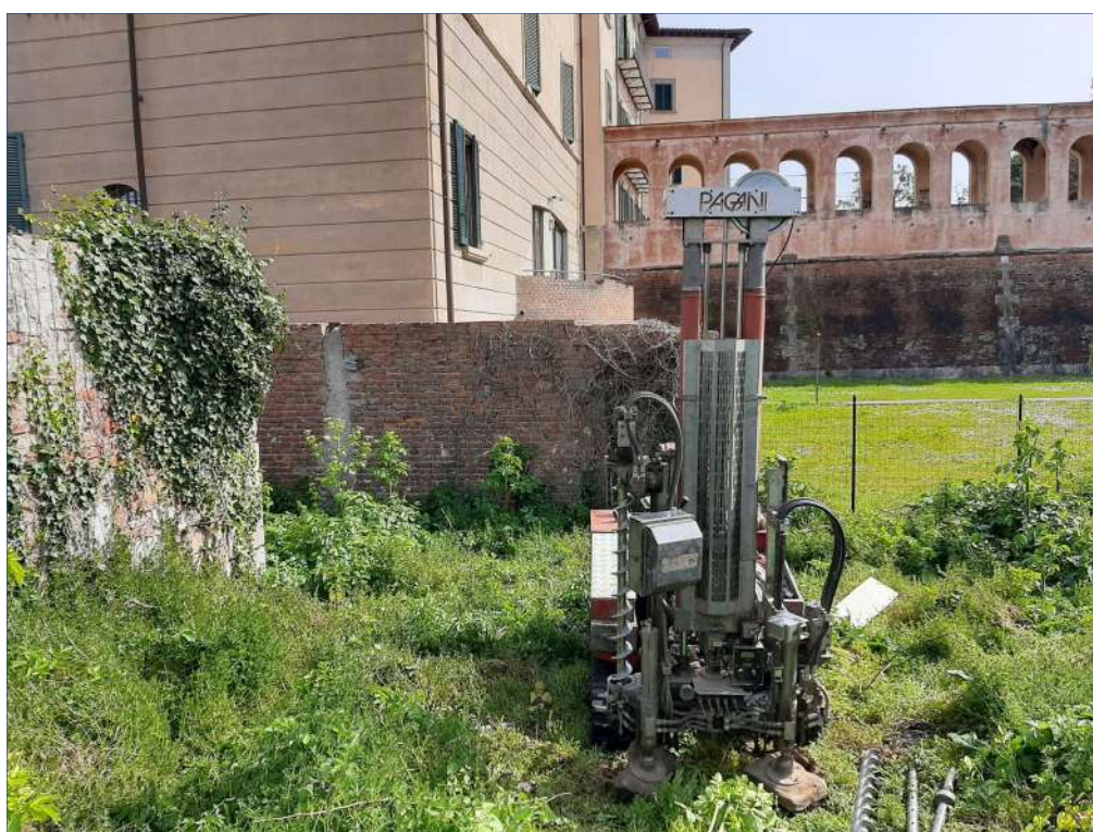
Figura 2: Postazione prova penetrometrica CPT 2
