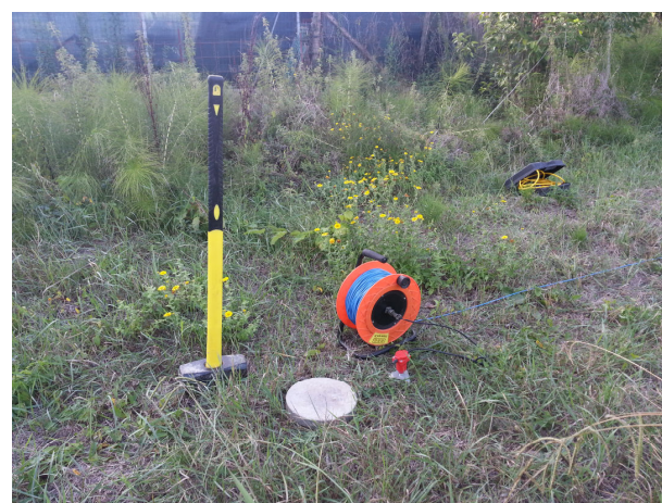
Sistema di battitura - Trigger
