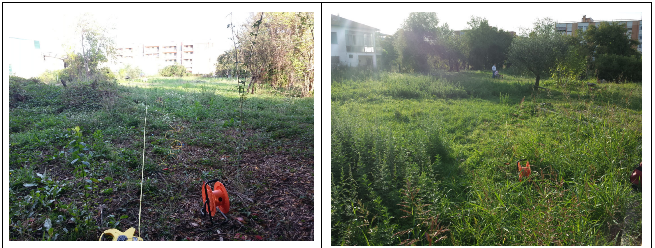
Sismica a rifrazione in onde SH: stendimento geofoni
