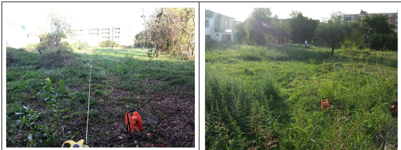
Sismica a rifrazione in onde SH: stendimento geofoni
