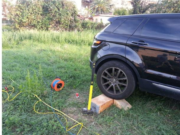
Per poter riconoscere in maniera inequivocabile sui sismogrammi le onde di taglio S, che non costituiscono mai la prima fase, sono state effettuate energizzazioni ai due estremi della tavola, in modo da generare treni d'onda identici, ma in opposizione di fase. Ogni energizzazione viene registrata sull'hard disk del computer sia singolarmente che, invertendo la fase, come somma.
