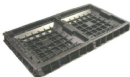
**Chiusino 60x120** a riempimento in ghisa sferoidale classe D 400 (rispondente alla norma EN 124). Permette il riempimento con qualsiasi tipo di materiale (porfido, basoli, granito), in modo da mantenere la continuità della pavimentazione.
