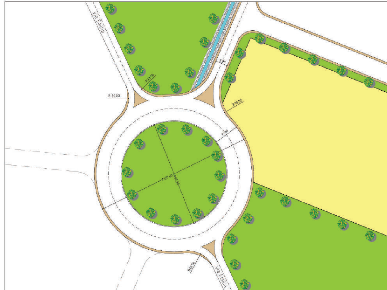
RORATORIA 1 TIPOLOGIA: ROTATORIA A DOPPIA CORSIA DIAMETRO DELL'ISOLA CENTRALE.....40 M DIAMETRO DELLA CORONA GIRATORIA 60 M
