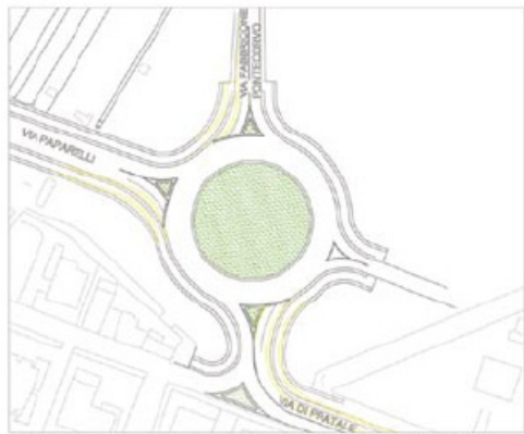
Adeguamento dei rami di ingresso della rotondina di via Paparelli
