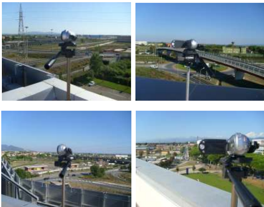
Foto 3 – Esempio di installazione per rilievo con telecamere
