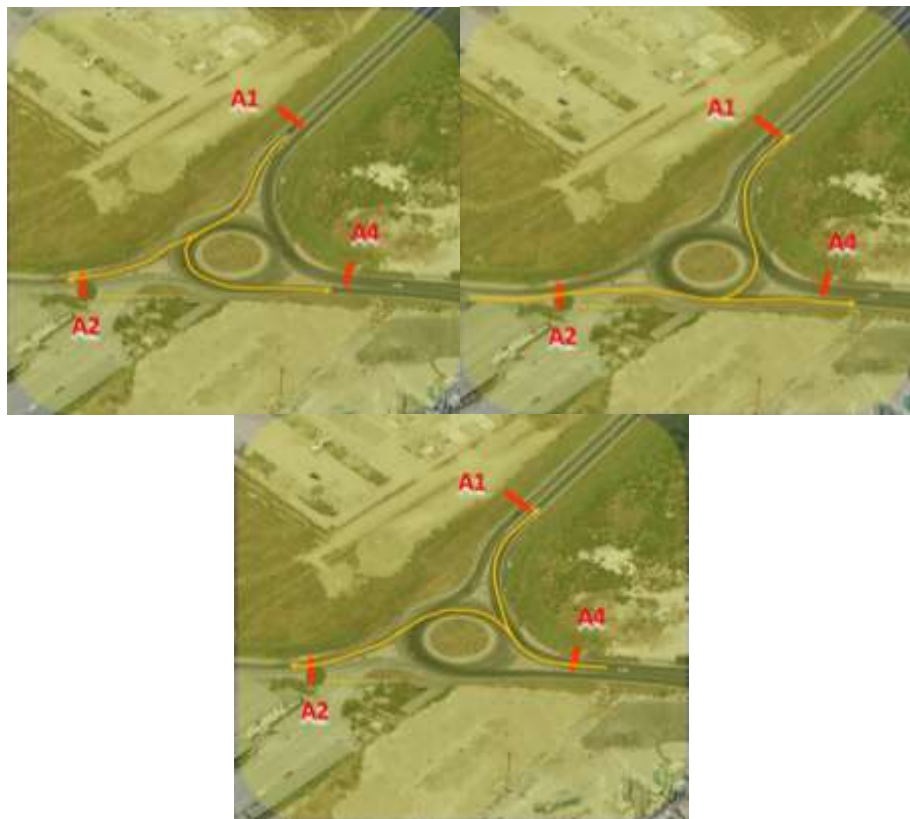
Figura 38 – Intersezione 1 – Sezioni di manovra
