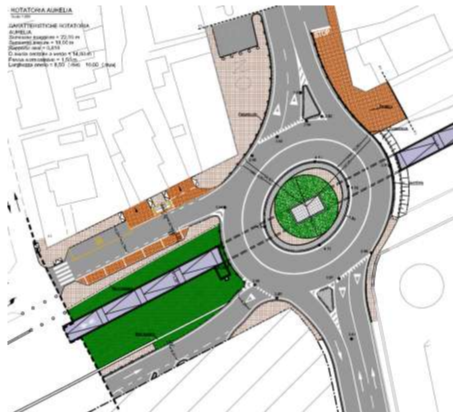
Figura 89 – Intervento 3 – Dettaglio dell'intersezione
