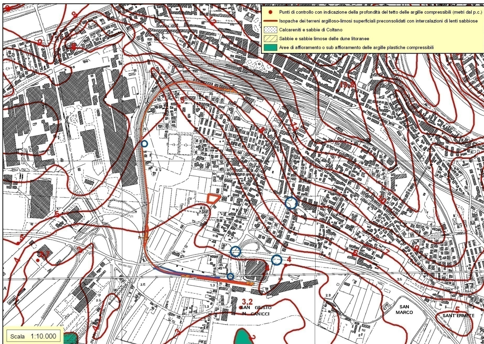
Fig. 16 PS - Carta Tetto argille compressibili
