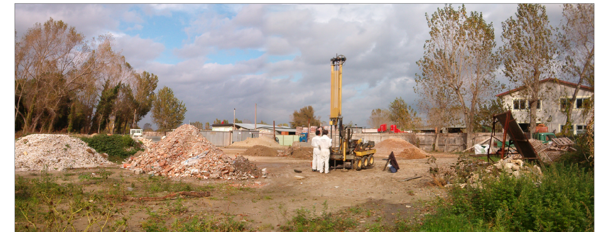
Foto n°5 : Panoramica parziale del sub-comparto oggetto del presente Piano Attuativo, ed esecuzione della prova penetrometrica statica CPT3, vista da SSO.
