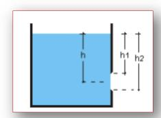
Figura 11 – Schema serbatoio di scarico e bocca di fondo
