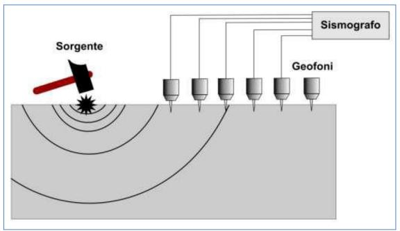
Figura 2: Esempio schematico di stendimento sismico tipo MASW
