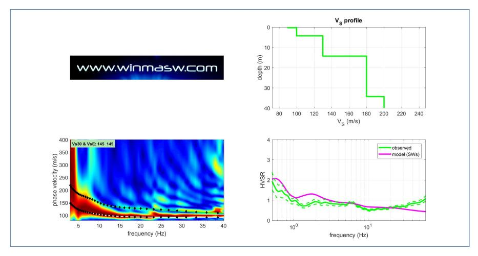
Figura 5 Sulla sinistra gli spettri di velocità relativi alla componenti ZVF con in sovrapposizione le curve di dispersione per l'onda di Rayleigh; Sulla destra in basso in verde le misure HVSR effettuate in sito e in magenta la curva HVSR modellata tramite ellitticità delle onde di superficie (Lunedei & Albarello, 2009); in alto il modello usato per la modellazione.
