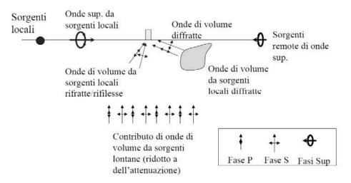
Figura 1: Modalità di generazione e propagazione di microtremore
