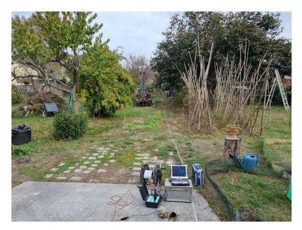
Figura 3: Stendimento sismico MASW1
