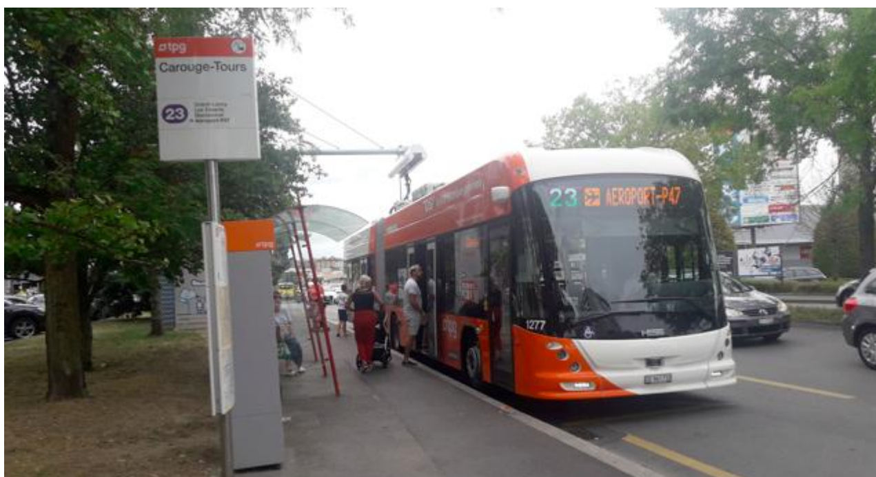
Fig. 35 – Ginevra, linea 23, fermata con punto di ricarica flash
