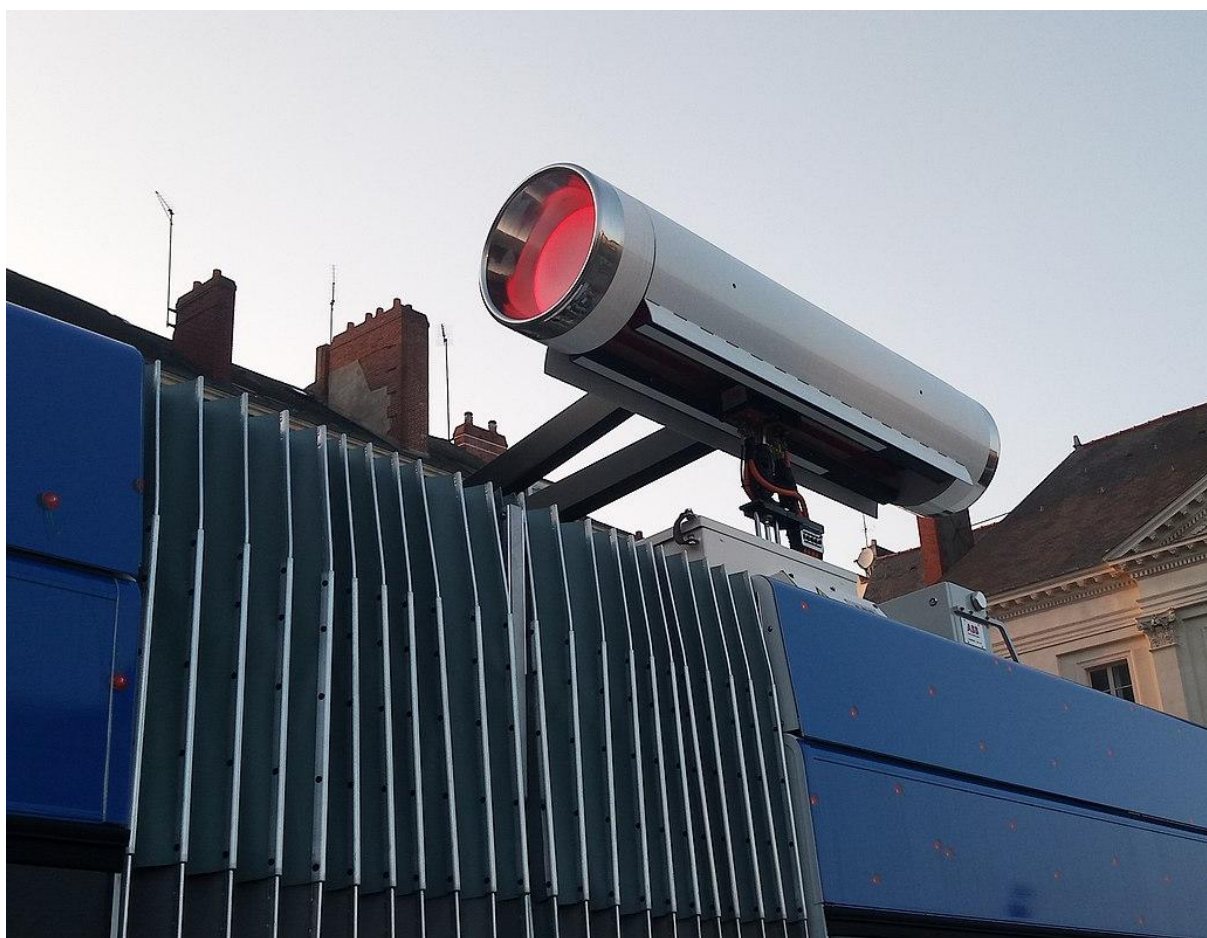
Fig. 38 - Dettaglio del braccio telescopico di captazione, in posizione di riposo, montato sul tetto della vettura in posizione laterale
