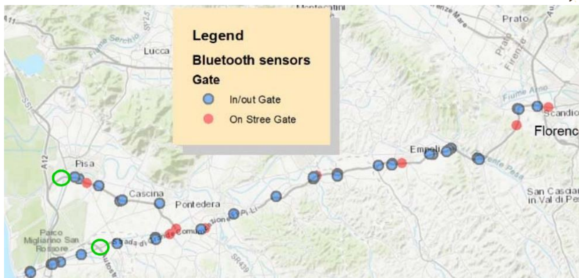
Figura 3.6.2 – Mappa regionale della distribuzione dei Bluetooth e dei sensori di traffico lungo la SGC Fi-Pi-Li 4 (in rosso i sensori lungo la SGC Fi-Pi-Li, in blu quelli ai varchi di ingresso/uscita e in verde le uscite dalla suddetta viabilità non monitorate)
