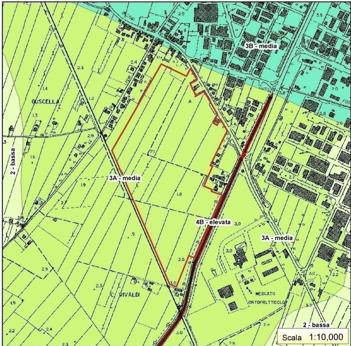
Fig. 7 PTC – Vulnerabilità idrogeologica (Nuovo INSEDIAMENTO MILITARE - Ospedaletto)
