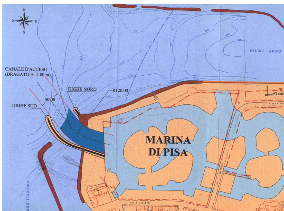
Figura 3 – Il layout portuale del 1998 con imboccatura lato fiume a valle (ad Ovest) della barra
