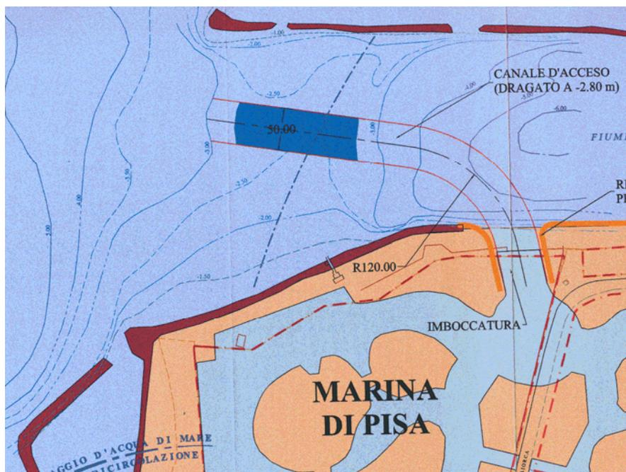
Figura 2 – Il layout portuale del 1998 con imboccatura lato fiume a monte della barra e canale dragato di accesso
