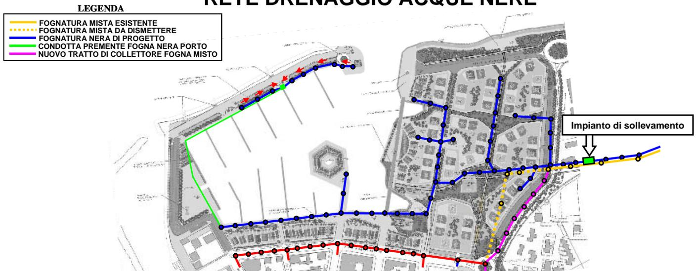
Figura 3a – schema idraulico della rete principale di drenaggio delle acque nere
