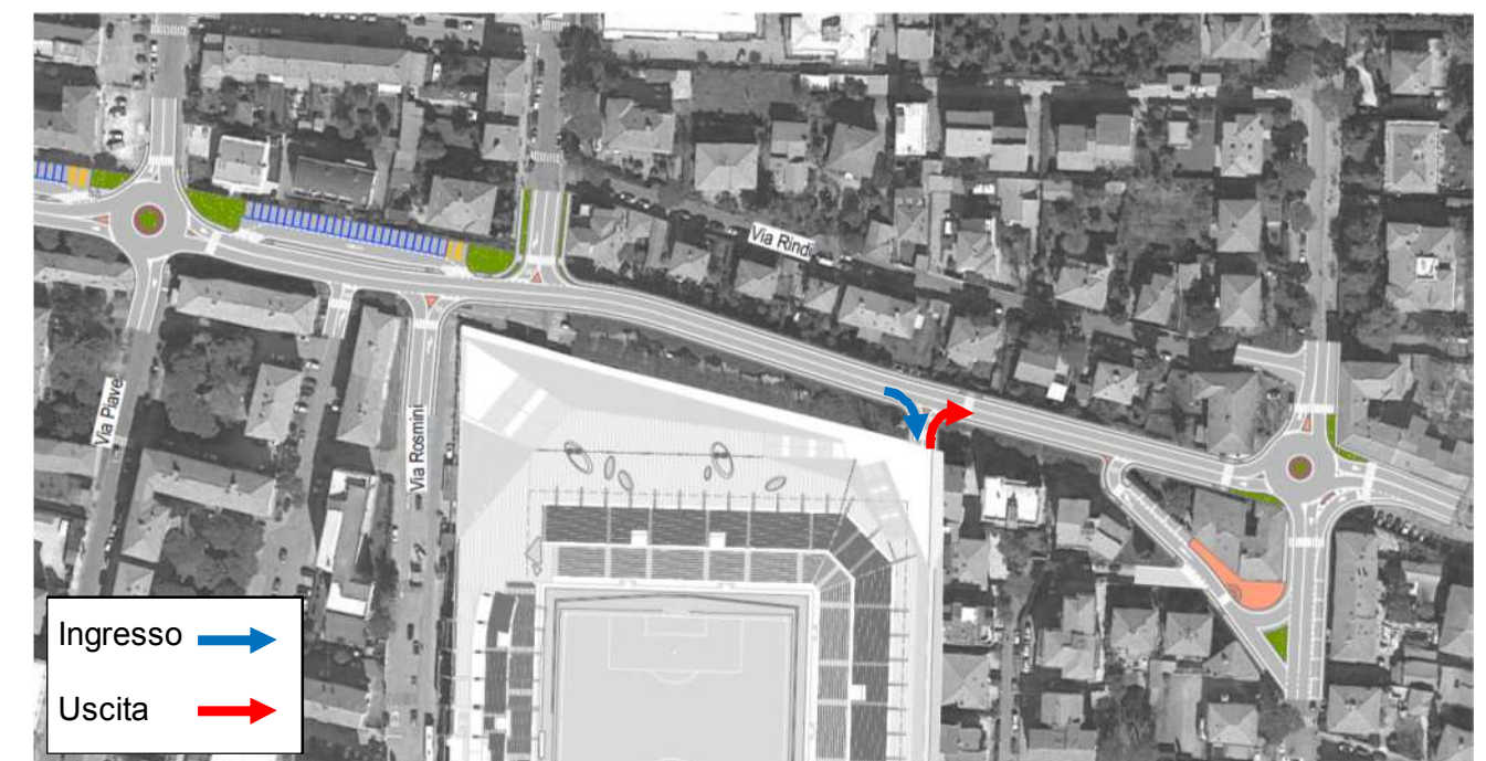
Figura 5.9 – Identificazione dell'accesso al parcheggio posto nell'angolo nord-est dell'impianto sportivo
