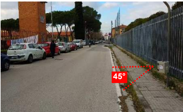
Figura 3.3 – Angolo di installazione dei radar rispetto alla direzione di marcia
