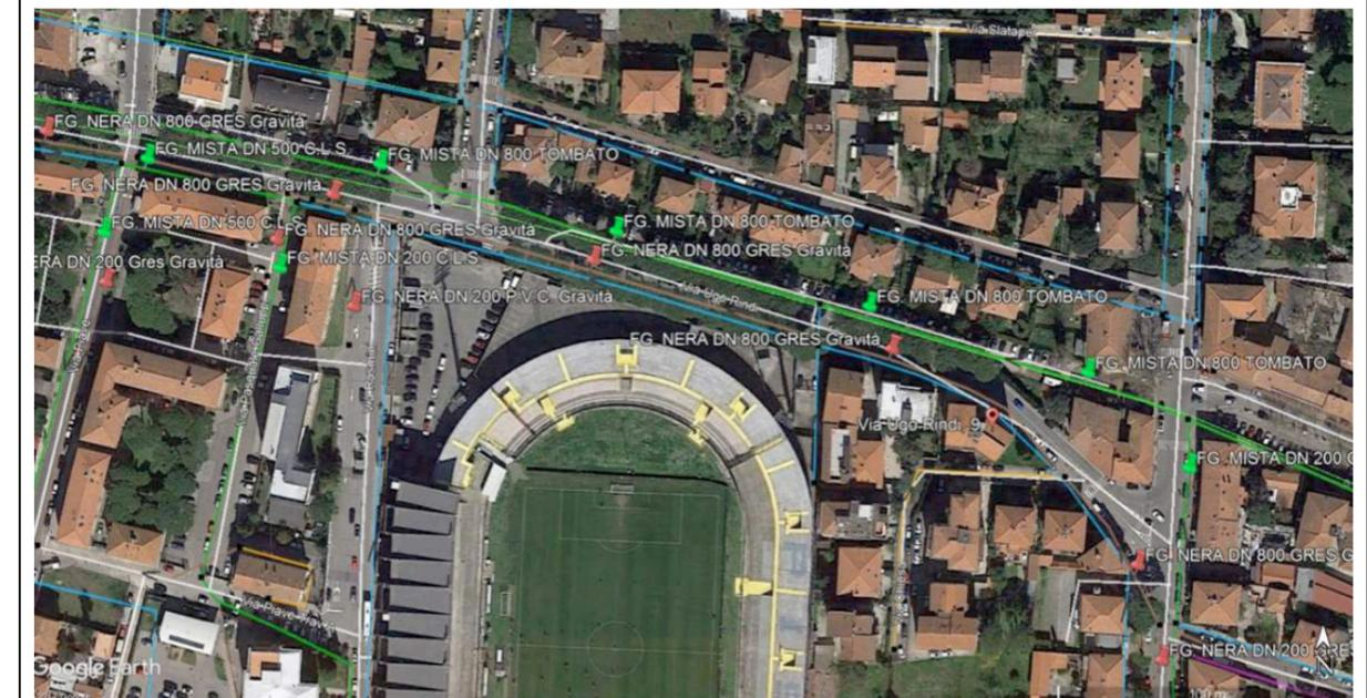
Fig.: schema reti fognatura nera e bianca/mista (fonte: Acque Spa)
