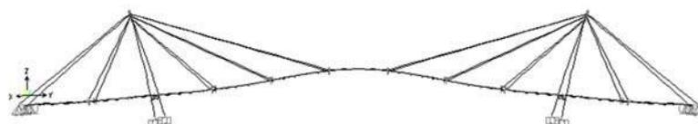
Figura 4.6- Deformata del primo modo di vibrare.
