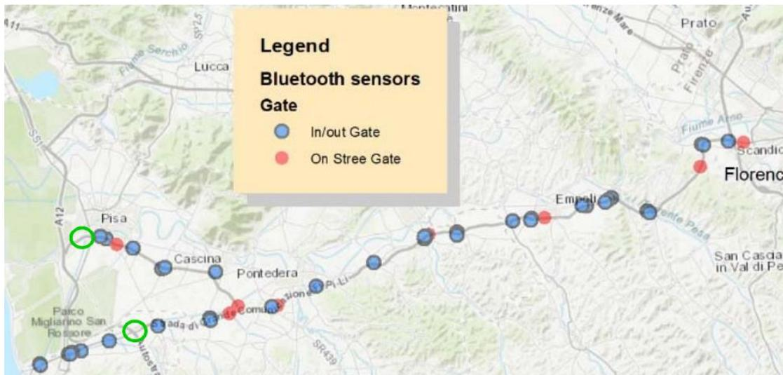
Figura 3.6.2 – Mappa regionale della distribuzione dei Bluetooth e dei sensori di traffico lungo la SGC Fi-Pi-Li<sup>3</sup> (in rosso i sensori lungo la SGC Fi-Pi-Li, in blu quelli ai varchi di ingresso/uscita e in verde le uscite dalla suddetta viabilità non monitorate)
