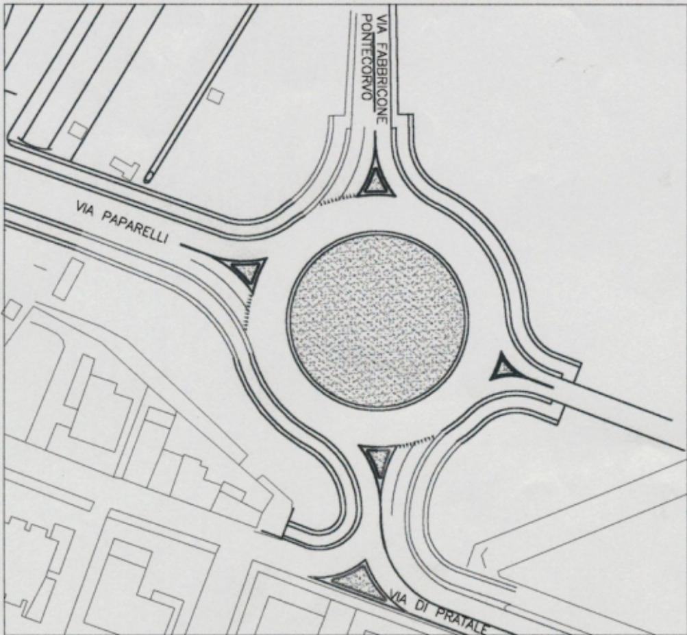
Fig. 2.9 - Adeguamento dei rami di ingresso della rotatoria di via Paparelli
