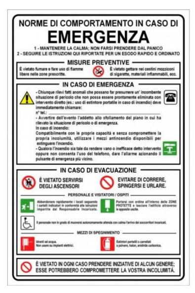
Si riporta al termine del piano operativo il piano di emergenza ed evacuazione previsto per il palazzetto dello sport.
