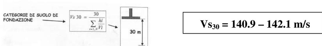
Il fatto che siano date due misure di velocità è dovuto al fatto che la  $V_{s30}$  viene calcolata sia sulla componente  $V_Y$  che sulla componente  $V_X$  della  $V_{SH}$ .
