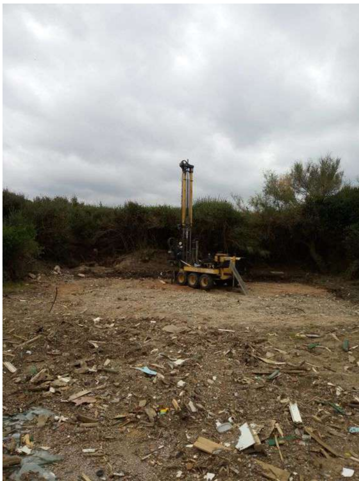
Foto n.2 : Postazione della prova penetrometrica statica CPT2 nel Comparto n.1
