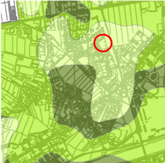
Microzone Omogenee in prospettiva sismica (MOPS)
