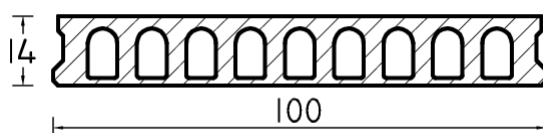
Figura 6.56 – Pannelli solaio di copertura
