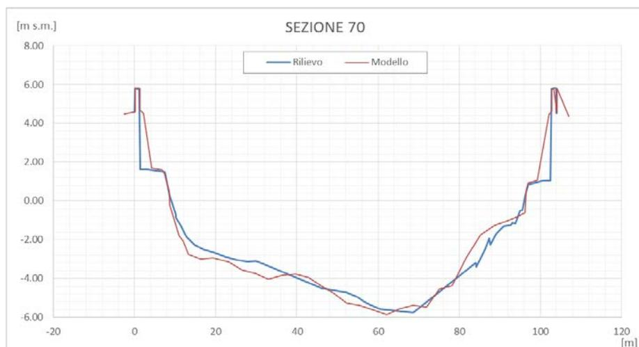
Figura 3-3 Sezione 70 del Fiume Arno – Confronto tra la geometria della sezione rilevata nel mese di Ottobre 2016 e quella precedentemente implementata nel modello idrodinamico.
