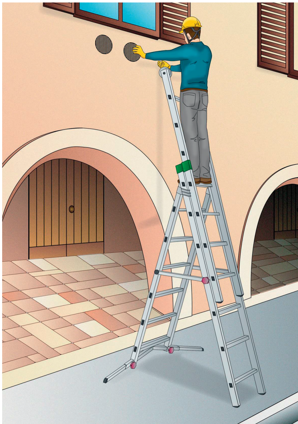
Figura 1 - Esempio di scala trasformabile a tre tronchi in configurazione doppia
