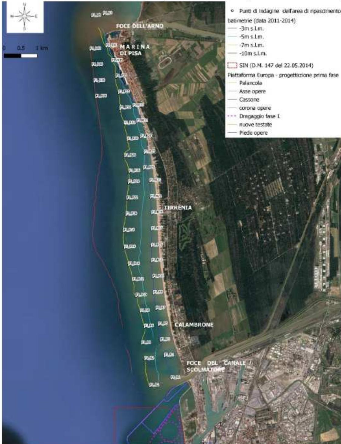
Figura 5.2 – Ubicazione dei punti di caratterizzazione proposti per la caratterizzazione della possibile area di ripascimento in area sommersa
