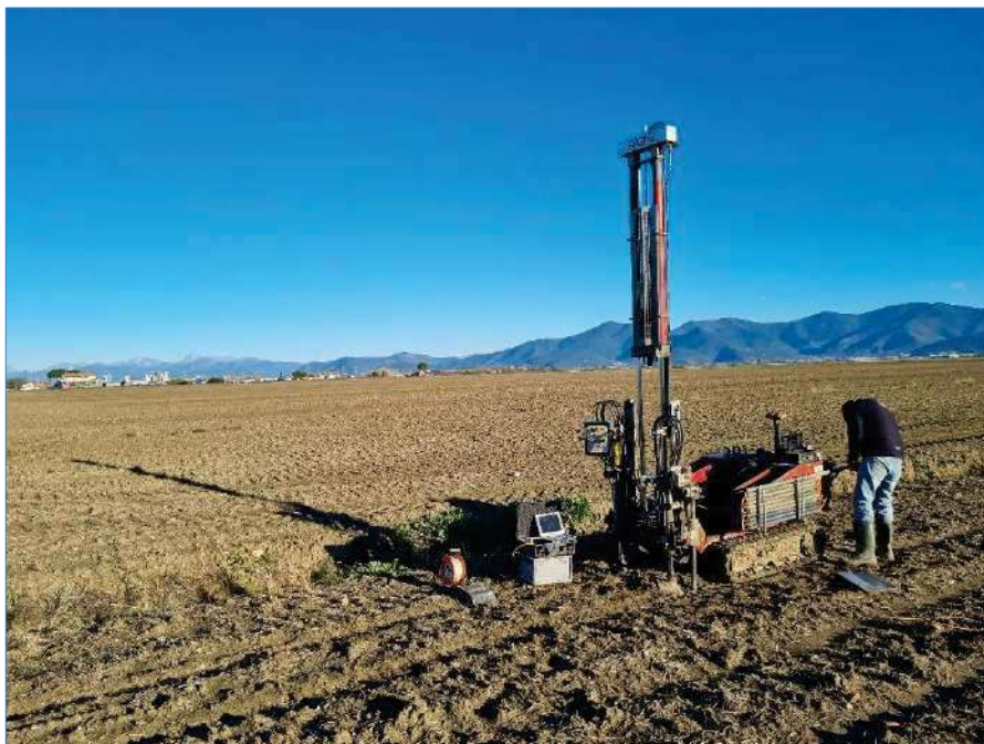
Figura 6: Prova penetrometrica CPTU 06
