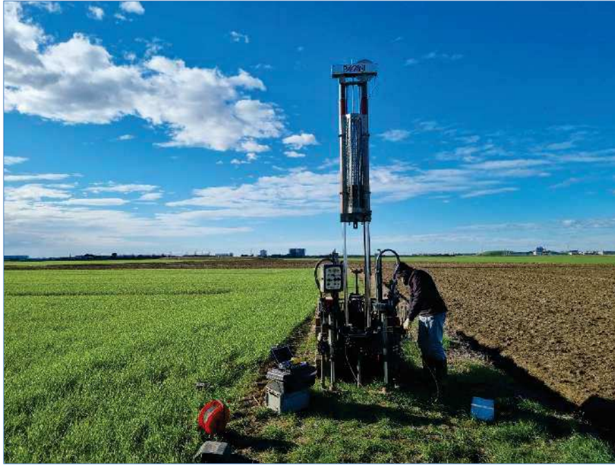
Figura 3: Prova penetrometrica CPTU 03
