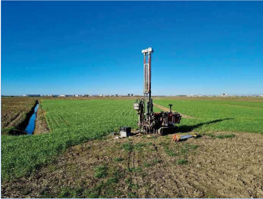
Figura 7: Prova penetrometrica CPTU 07
