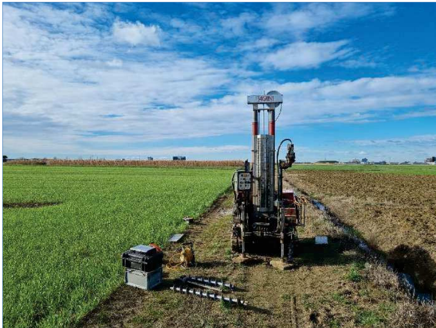
Figura 2: Prova penetrometrica CPTU 02
