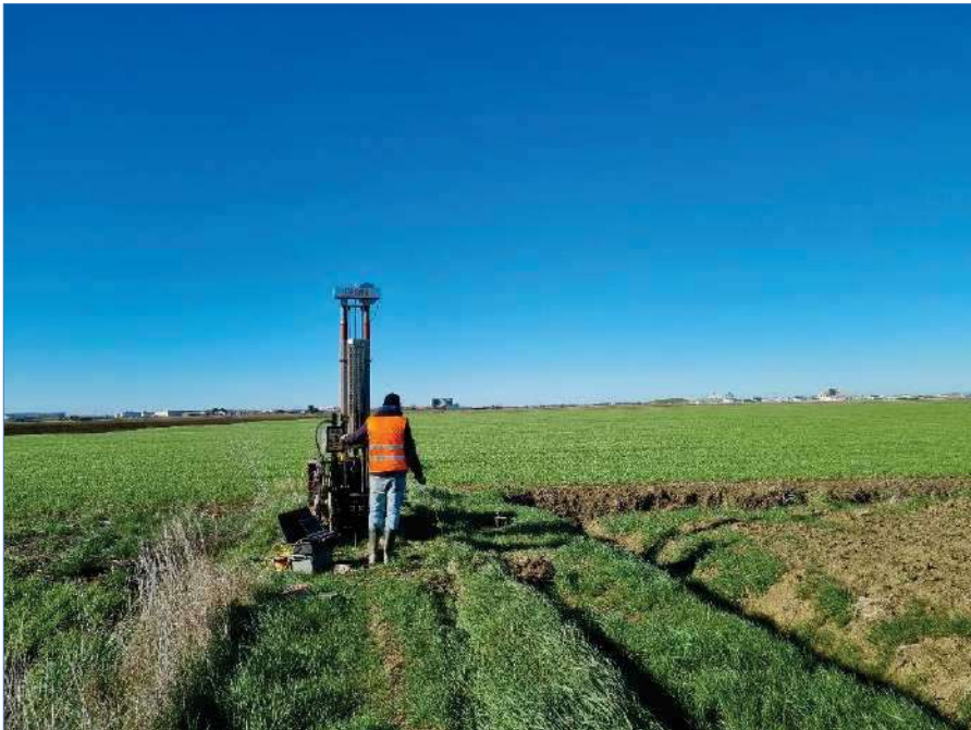
Figura 8: Prova penetrometrica CPTU 08
