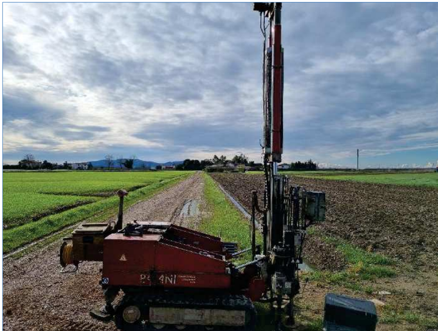
Figura 1: Prova penetrometrica CPTU 01
